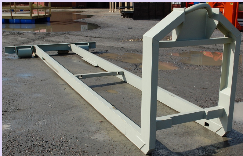
Blästrade & grundmålade, färdigmonterad hjulbalk
